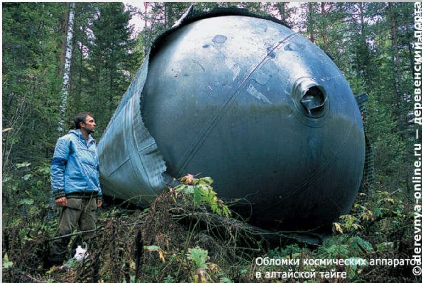
Рис. 23. 2-я ступень РН «Протон» после падения в алтайской тайге. По: «Алтай – Космос – Микрокосм» / Дельфис. 1998. №3. [ http://www.delphis.ru/journal/article/altai-kosmos-mikrokosm ]
