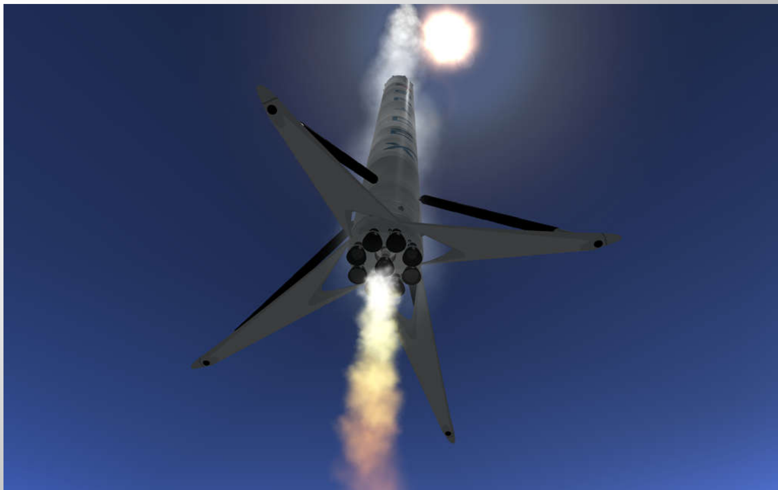
Рис. 41. Изображение конструкции посадочного устройства первой ступени ракеты-носителя Falcon 9 в процессе посадки.
