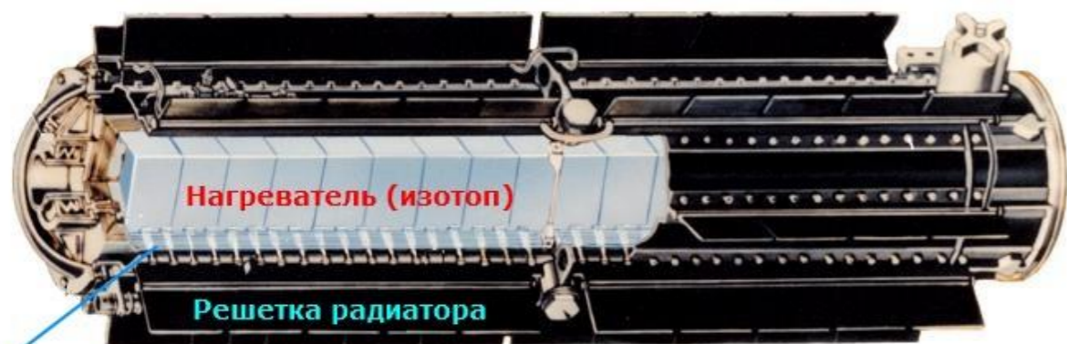
Термоэлектрический преобразователь (ряд биметаллических пар)
