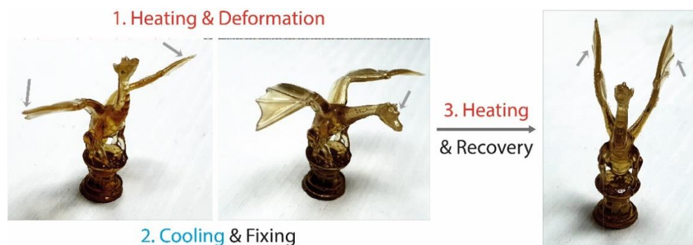
Рис. 1. Демонстрация ЭПФ трехмерной структуры, сформированной с использованием LCD 4D-печати.
