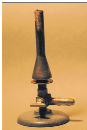
Газовые горелки (латунь, чугун, сталь, 1950-е годы). Слева – горелка завода Физприбор, г. Киров, 1958 год (по этикетке)
