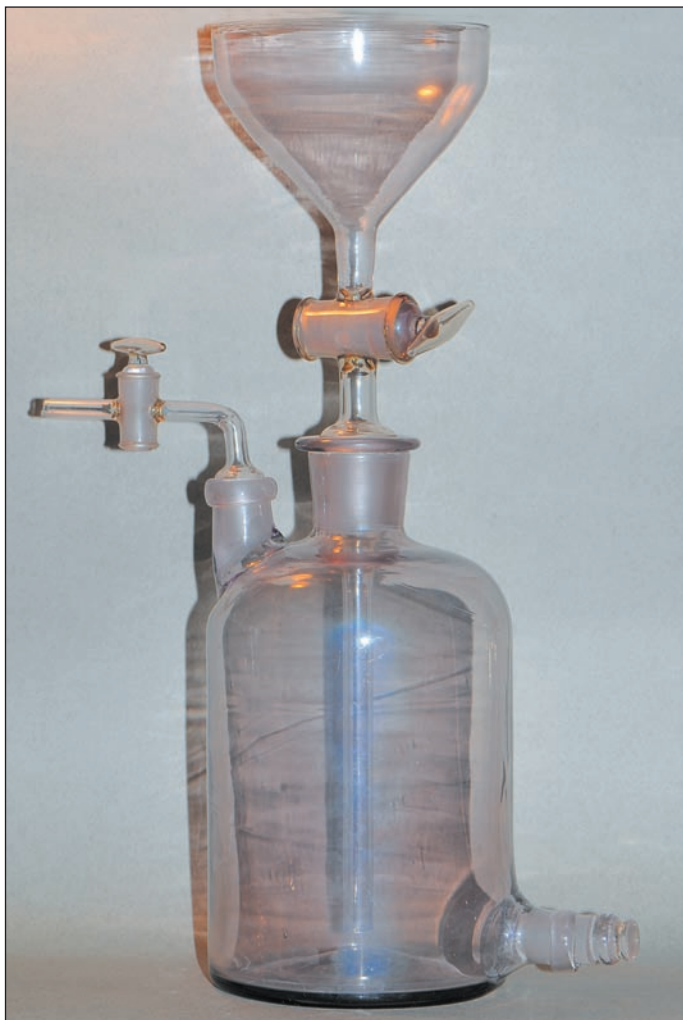
Газометр и аппарат Киппа, начало XX века
