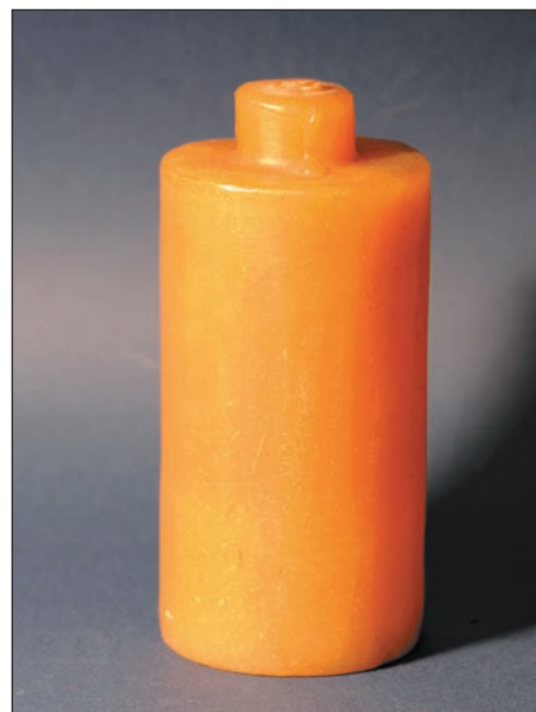
Парафиновая банка для плавиковой кислоты, начало XX века
