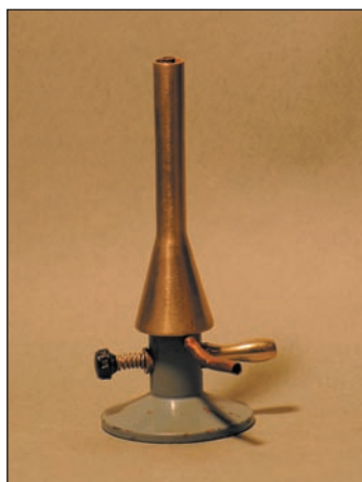
Газовые горелки (латунь, чугун, сталь, 1950-е годы). Слева – горелка завода Физприбор, г. Киров, 1958 год (по этикетке)
