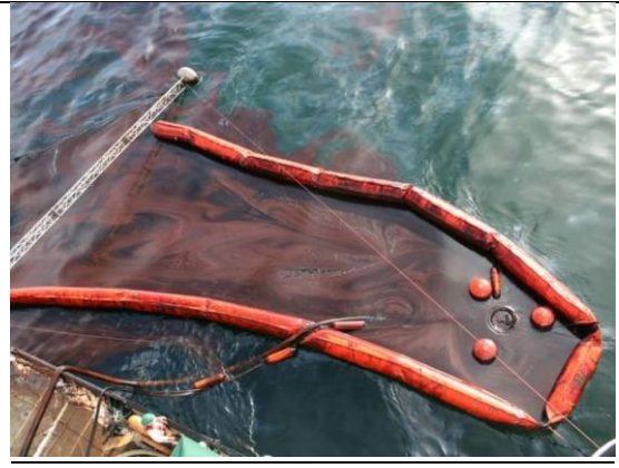
Сбор нефти циклонным скиммером
